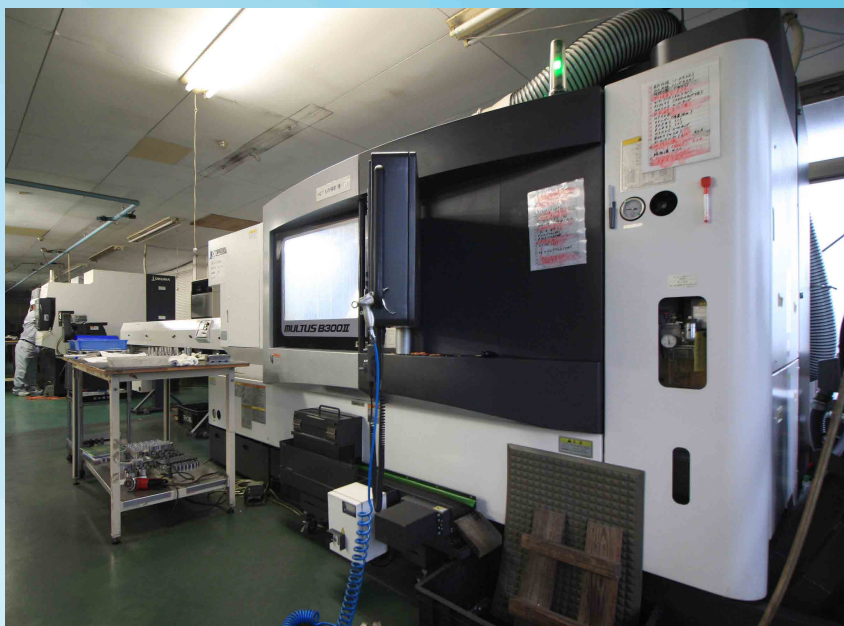
導入した高精度・高剛性・高機能が特長の複合加工機
