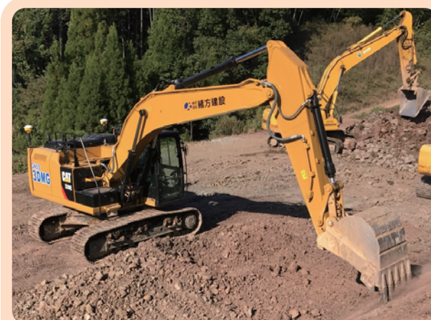
3Dバックホウガイダンスシステムを搭載した油圧ショベル
