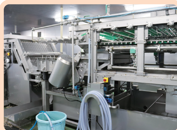
UDラインの根取り、殻取り、脱水の部分
