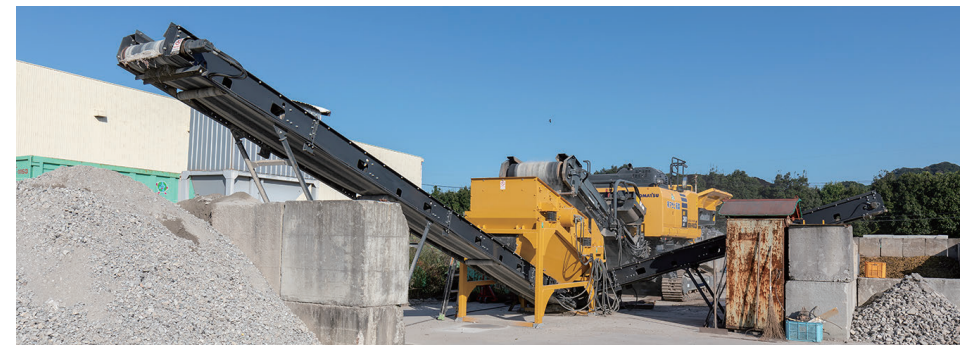
全長 20 メートルの最新モデル骨材製造プラント。県内に 2 機しかない。
