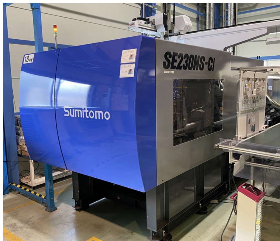
2組の射出装置を使って1度の成形工程を可能にする2材射出成形機
