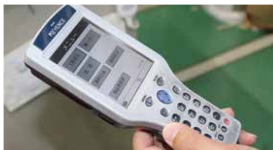
原料の出庫・投入に利用するハンディターミナル
