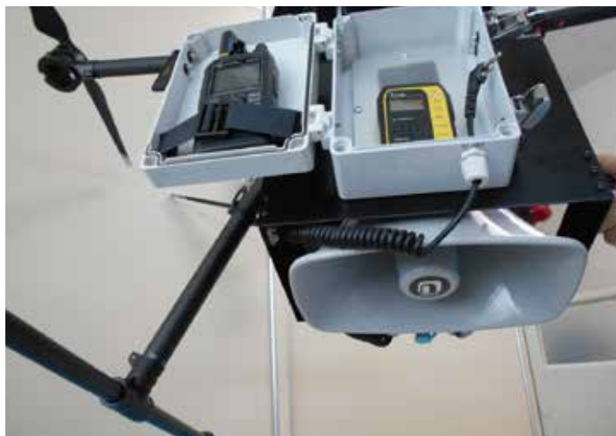
ドローンに収納されたIP無線
