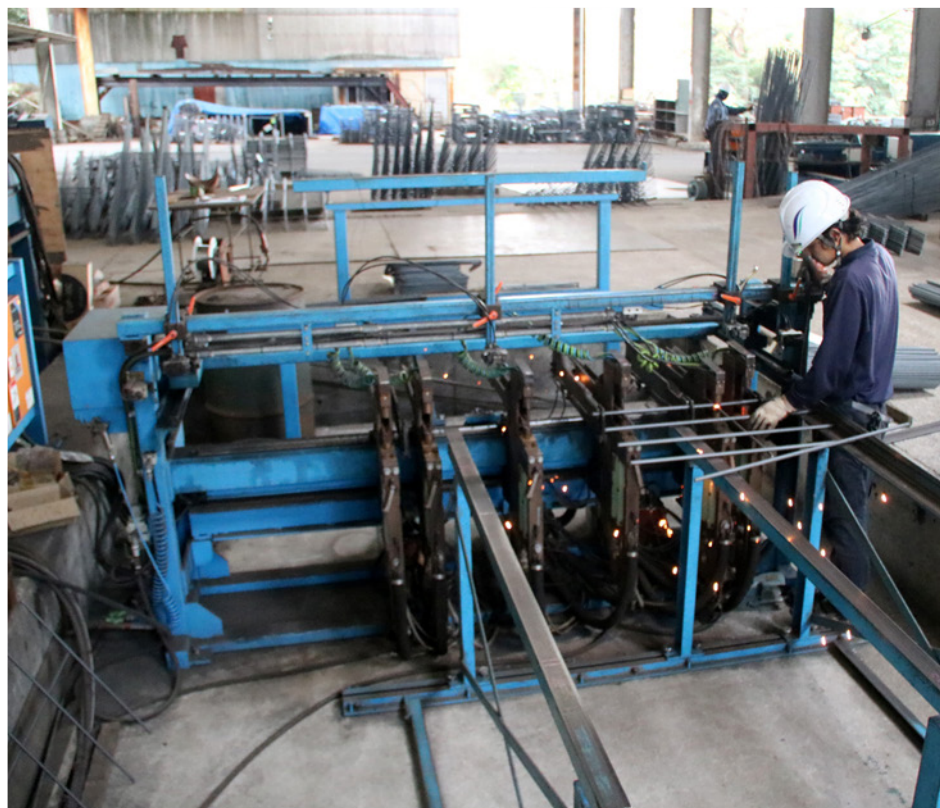
最新鋭となるトムテック製の6点スタラップ溶接機
