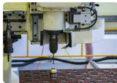
手作業で行わざるを得なかったネジ加工が精密な機械作業になったことで、一定の品質が確保できるようになりました。
