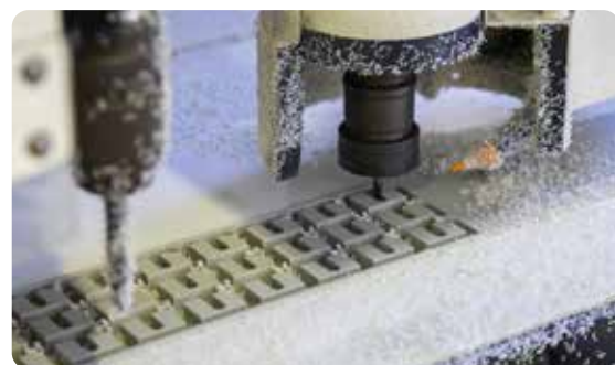
外注に頼っていた1/100mmの切削加工ができるようになり、コスト削減にもつながりました。
