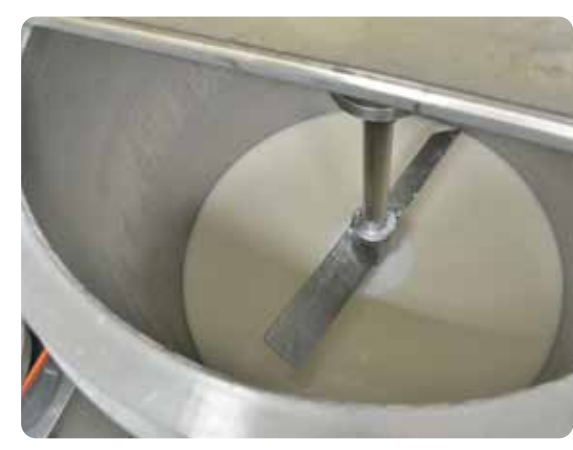
新しく導入したタンク で仕上げた甘酒を裏 ごし。これまではこし 器とゴムべらで作業 をしていましたが、機 械の導入で作業効率 が倍になりました。
