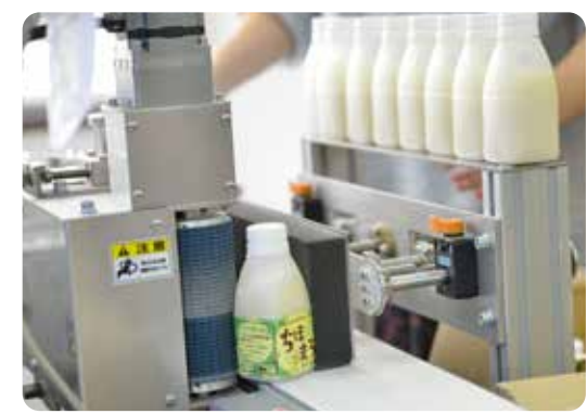
1本1本手作業で 行っていたラベリ ングも専用装置 で自動化。
