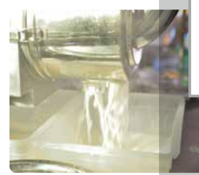
新しく導入したタンク で仕上げた甘酒を裏 ごし。これまではこし 器とゴムべらで作業 をしていましたが、機 械の導入で作業効率 が倍になりました。
