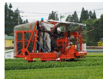
当社開発のロボット摘採機
