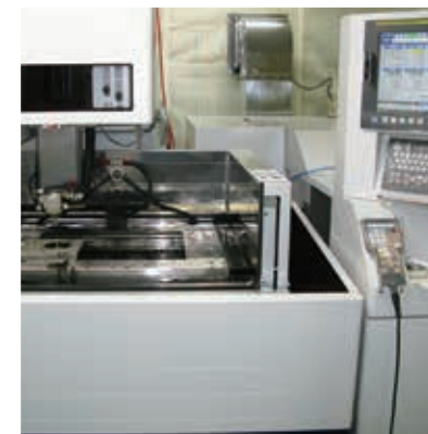
今回導入した、高精度ワイヤーカット加工機
