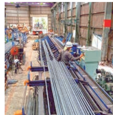
自動切断機作業状況
