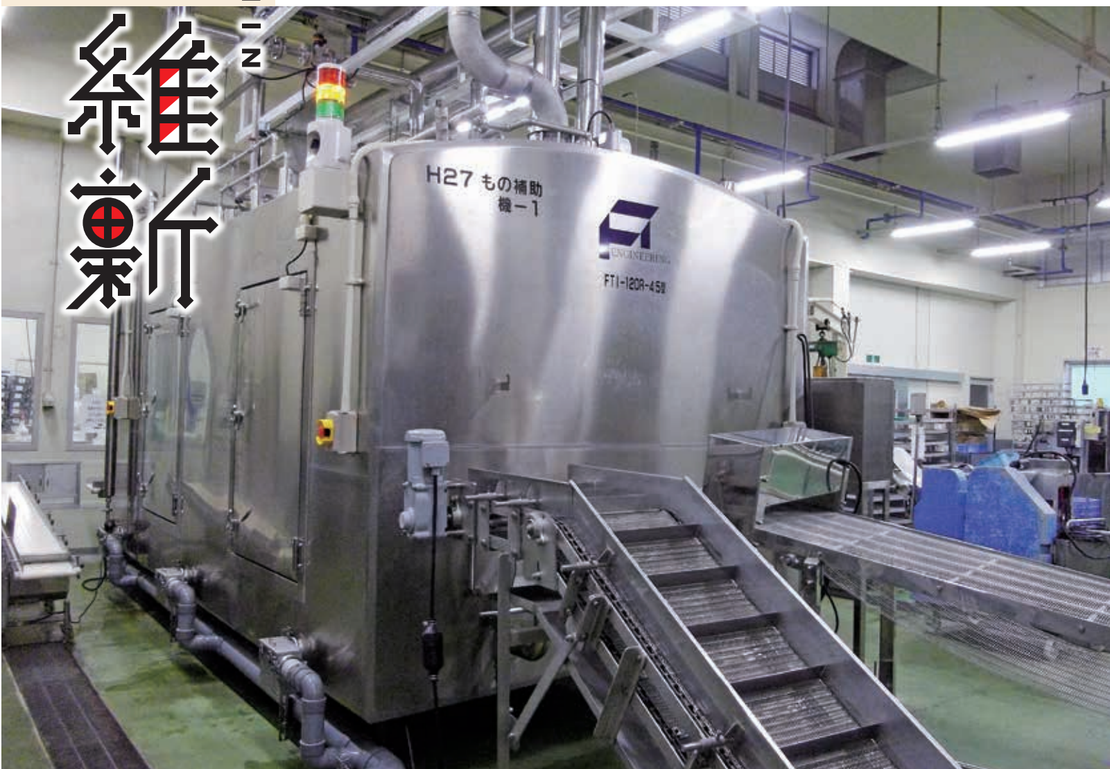
インピンジメントフリーザー（IoT対応仕様）（型番:FTI-120R-4.5型）
