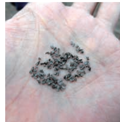
ショットブラストでは鉄粒を噴き付ける
