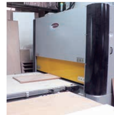
BONDEX-40L型で骨組みに合板を接着する様子
