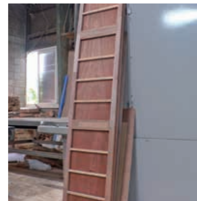
合板接着前の骨組み（芯材）
