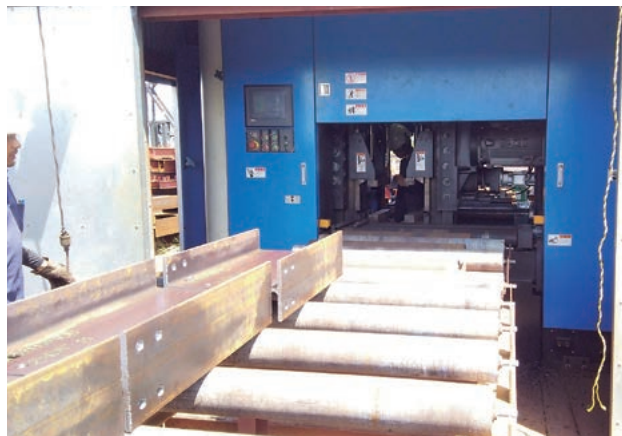
導入したH形鋼自動開先加工機（西原工場）
