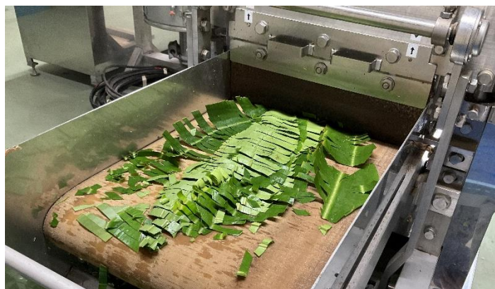
高速裁断機によるカットの様子
