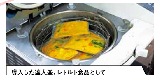
導入した達人釜。レトルト食品として安全性を保ちながら細かくこだわった加工が可能
