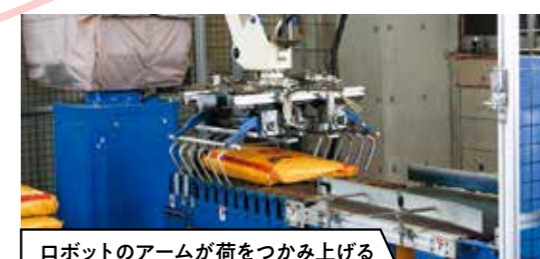
ロボットのアームが荷をつかみ上げる
