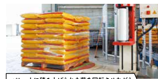
パレットに積み上げられた荷を回転させながら透明なビニールで包んでいく
