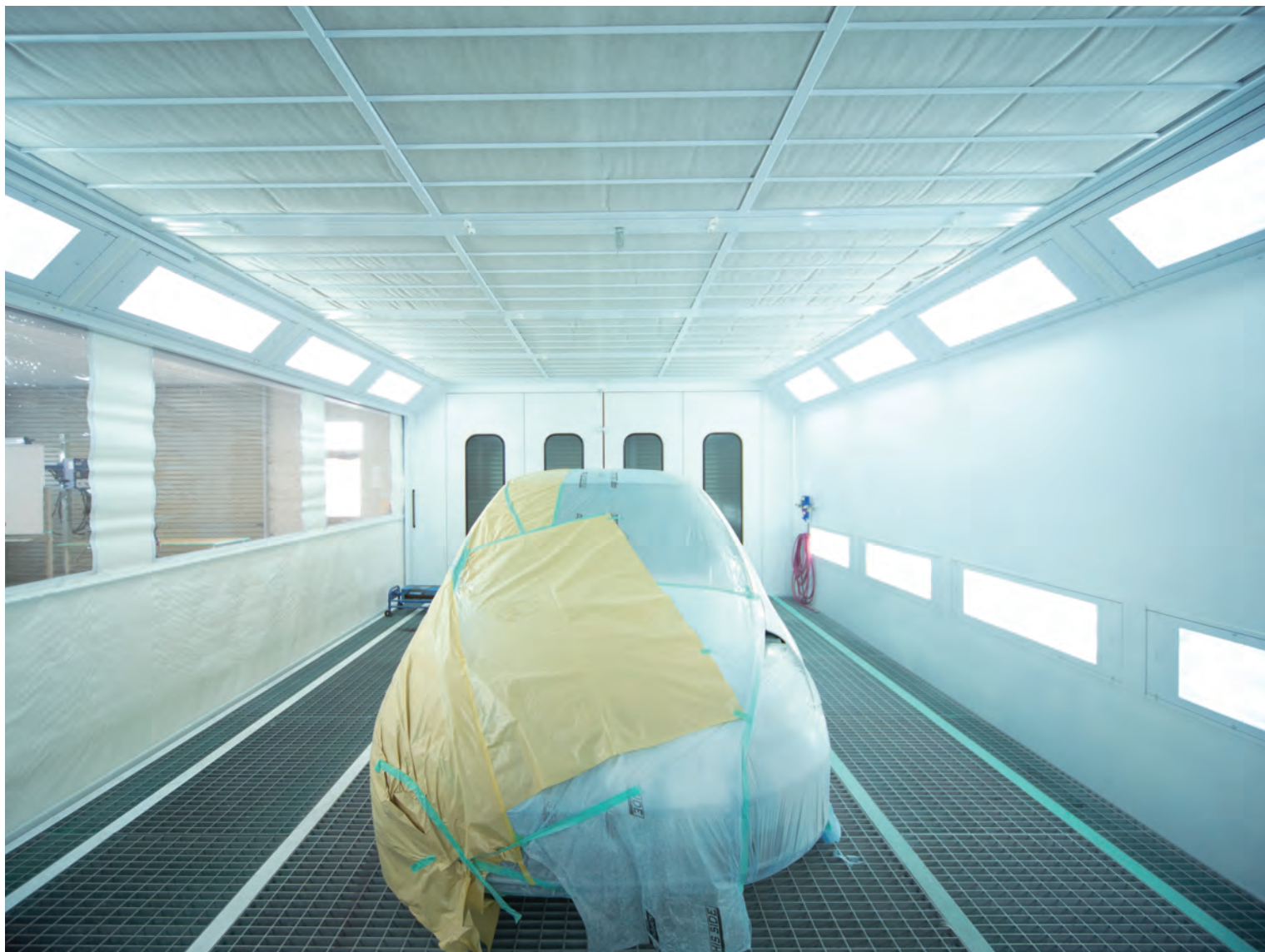
湿度や温度、空調を管理できる水性塗料専用の塗装ブース
