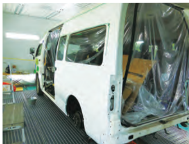
床全面をグレーチング(アミ状)にし、乾燥時間を短縮
