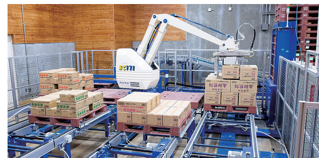
バーコード情報をもとにパレットに製品を積み付けるパレタイズロボット。
