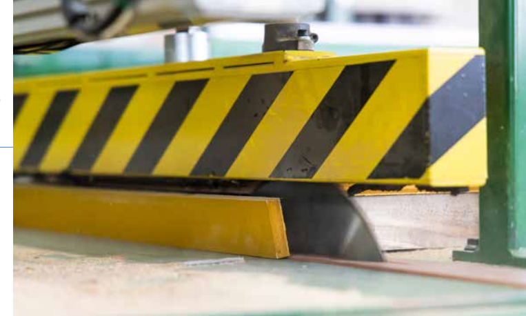
釘打ちや穴あけを終えた型枠を、下側から出てくる丸ノコで裁断する。手作業よりも飛躍的に効率が上がり、安全性も確保された。
