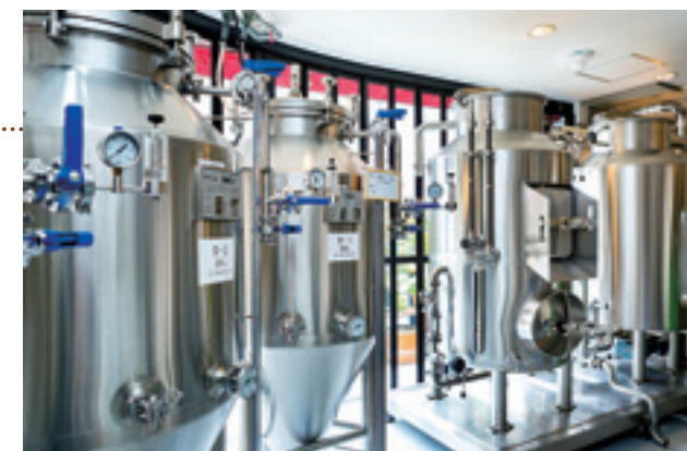
レストランに併設された200ℓビール醸造設備。
