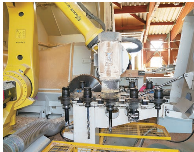
切削アタッチメントの自動付け替えの様子
