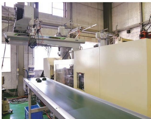
導入した電気式高性能射出成形機と射出成形品取出口ロボット
