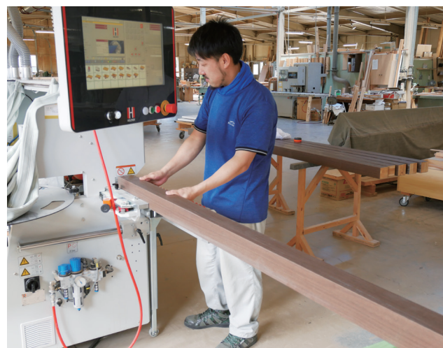
導入したエッジバンダーによる化粧板貼り付け作業
