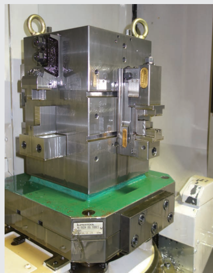
▲方体イケールの4面に加工物をセット。 テーブルの回転により多数個の加工が可能。
