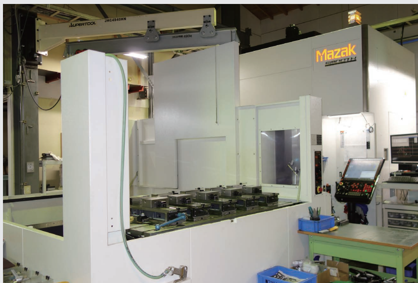
◀高速・高精度加工の門形マシニングセンタ。 最大加工範囲はX1.500×Y800×Z660mm
