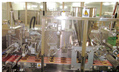
餡充填・耳締め機 SDR-AM-24A
