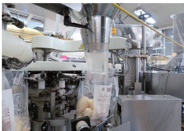
最新式堅型袋詰真空包装機を導入
