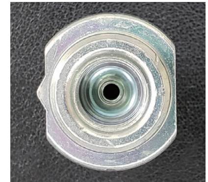
（写真上）従来の照明で照らすと、孔底の部分にまで光が当たっていない（写真下）専用照明で照らした場合、従来のような奥まで光をあてることが可能になった
