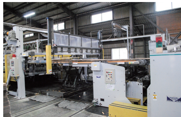
印刷機と糊付け機を連結した状態
