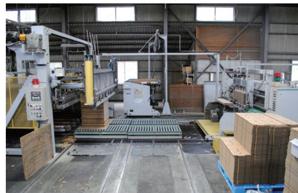
連結部分を切り離し、印刷機、糊付け機を単体で使用する
