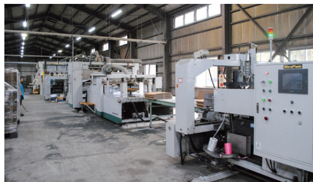
印刷機から送られてきたダンボール、または型抜きを施したものを糊付けする機械
