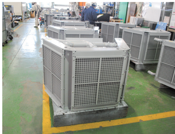
製缶フレームに銅製熱交換器を組み込んだ冷却装置
