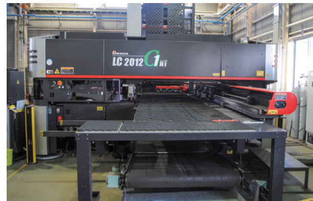
導入した「レーザ・タレットパンチング複合加工機」。これ1台で裁断から穴開けタッパまでを一気に行う
