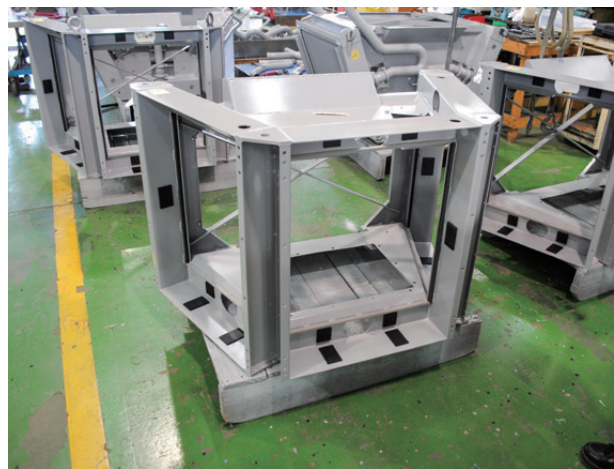
新規導入した複合加工機で製作した製缶フレーム
