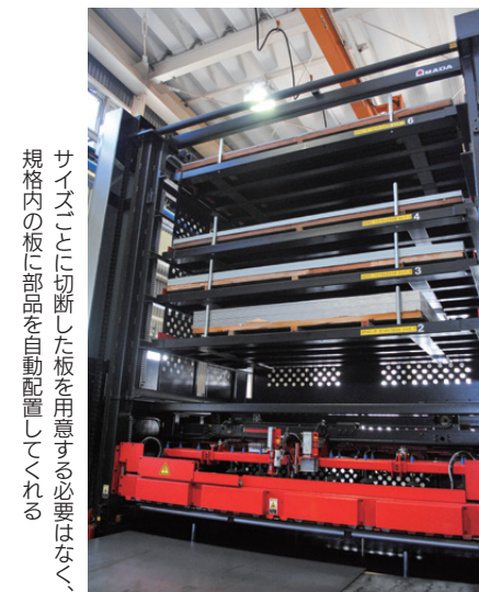
導入した「レーザ・タレットパンチング複合加工機」。これ1台で裁断から穴開けタッパまでを一気に行う
