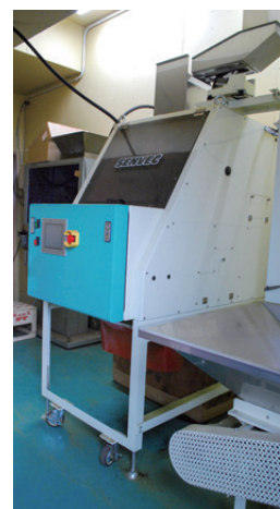
茶葉専用画像処理異物除去装置。新茶の時期、最高品質の緑茶を製造する際に使用している
