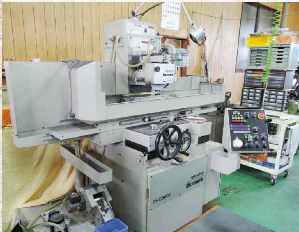
精密成形研削盤 PFG500DXPL II (Okamoto)
