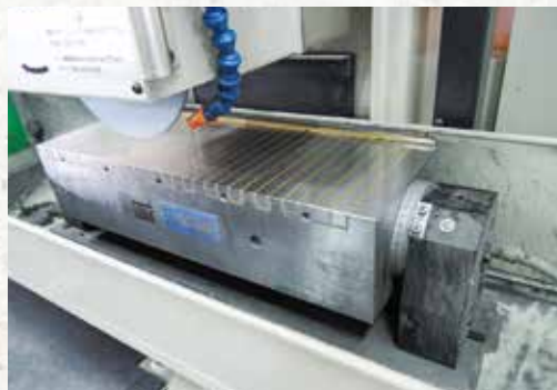
成形研削盤の上に載せた回転傾斜式テーブル
