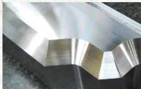
6面研磨加工など複雑な傾斜面の加工例
