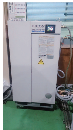
導入した金型冷却機で成形品の過熱を抑える
