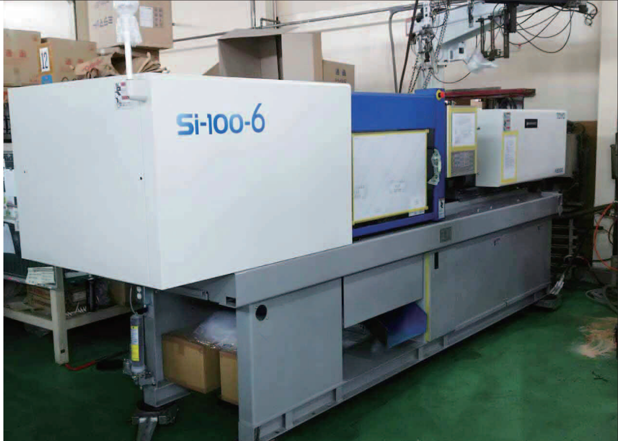
導入した電動サーボ式射出成形機は耐金属腐食性を備える
