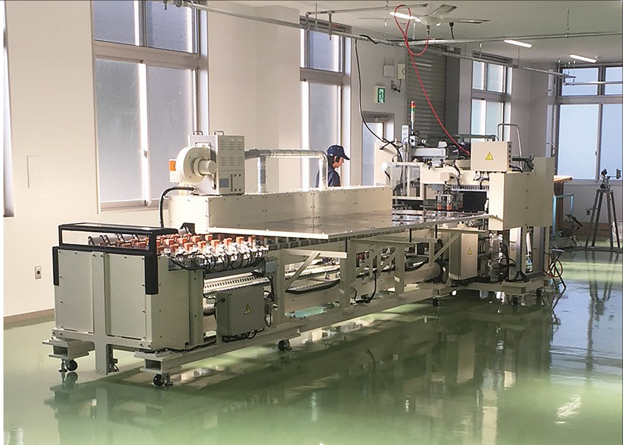
特許も取得した国内唯一のゴルフクラブ自動組み付け機
