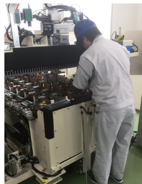
機械の導入で一部の接着作業が自動化された
