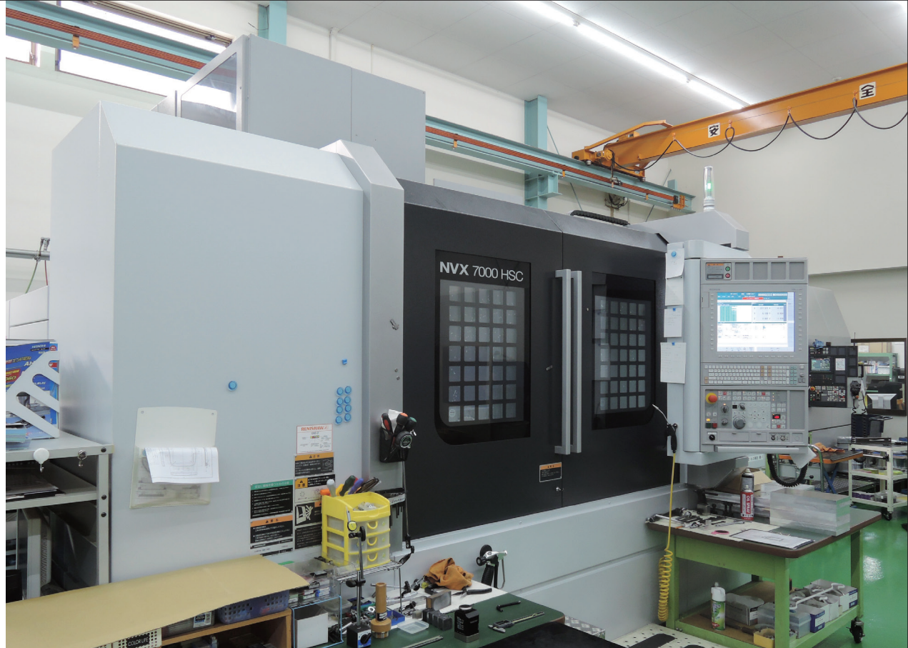
導入したマシニングセンタで従来の1.5倍の大きさの製品加工に対応する
