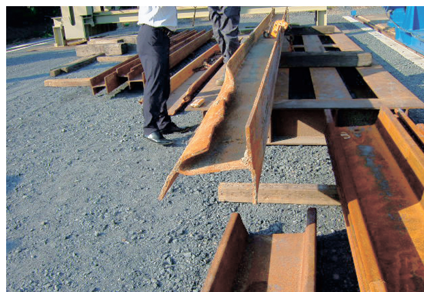
先端部が変形し、再使用不可能なH形鋼 (高さ300×幅300×t15×長さ10m)
