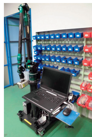
多間接型非接触式三次元座標測定装置 『ベクトロン非接触システム VMC-6600M II pls』
