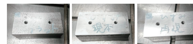
A CADデータにより作成 B 溶接により歪みが生じたサンプル C 非接触装置にて測定したデータに基づきB受け部を再現したもの
