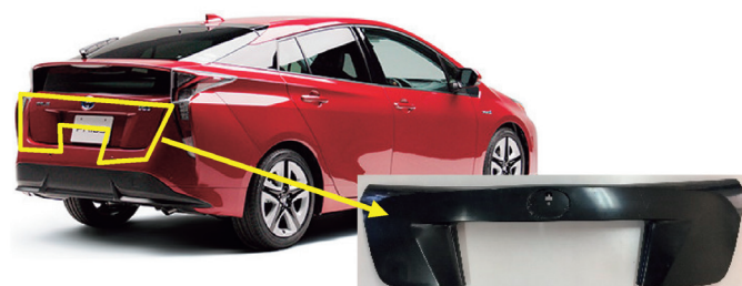
SGウェルドレス成形技術で軽量化したプリウスのバックパネル
