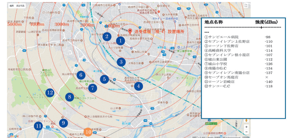
試験結果プロット図 (5km以上と見通しにより電波が届く)
