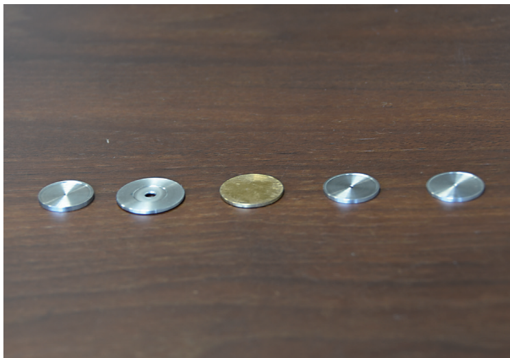
新規導入した平面研削機で研削したゲージコイン
