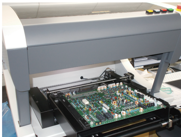
機械上部にカメラが付いており、基板の実装ミスをチェックする
