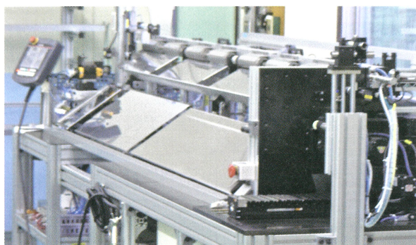
POINT2：特殊スプリング自動研磨加工機 (平成24年度ものづくり補助金対象事業)
