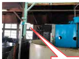
カメラ、機械で削った切粉の状態を観察できる。
