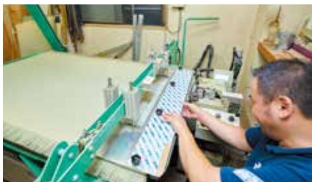
東海機器工業株式会社製エア式/框裁断機付框縫機 『東海ホープTA2』
