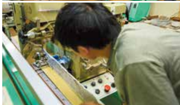
東海機器工業株式会社製自動クセ取装置付き両用縫着機 『東海マイコンスーパーリード6型』
