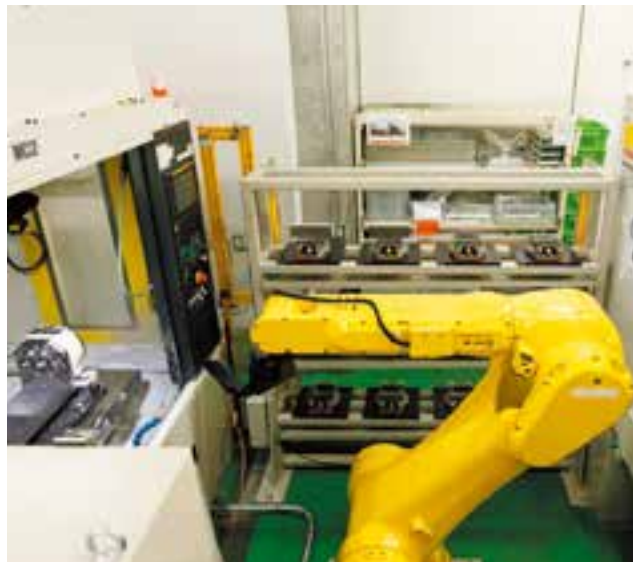
2台のマシニングセンタを1台のロボットが切り盛りする
